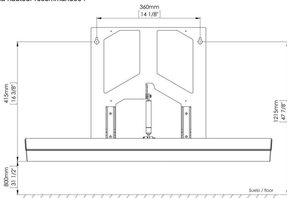
En suivant le schéma antérieur, marquer à l'aide d'un crayon sur le mur les deux trous supérieurs de la structure de fixation de la table à langer. Il est important de s'assurer que les emplacements marqués au crayon pour les trous de montage soient au même niveau avant de percer.
