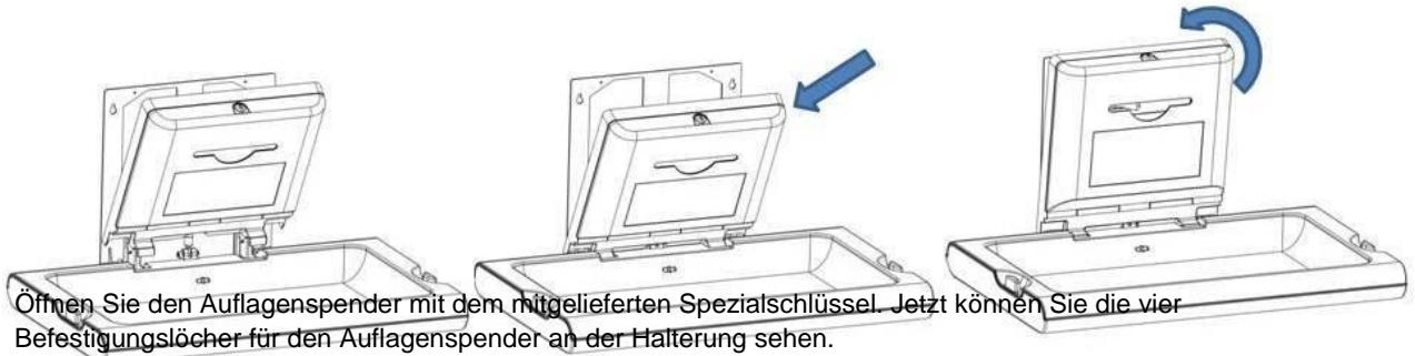
Positionieren Sie den Spender auf der Halterung und richten Sie die Befestigungslöcher aus.
