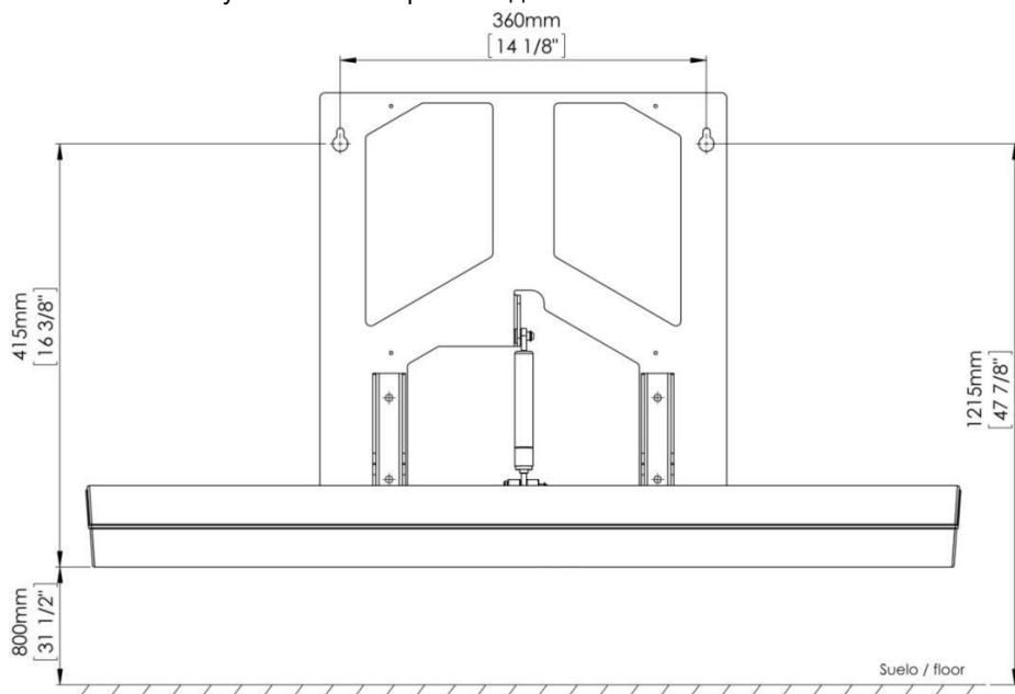
Следуя предыдущему рисунку, поставьте карандашом на стене пометки для двух верхних отверстий для крепежной структуры пеленального стола. До начала сверления отверстий очень важно убедиться в том, что поставленные карандашом пометки находятся на одном уровне.
