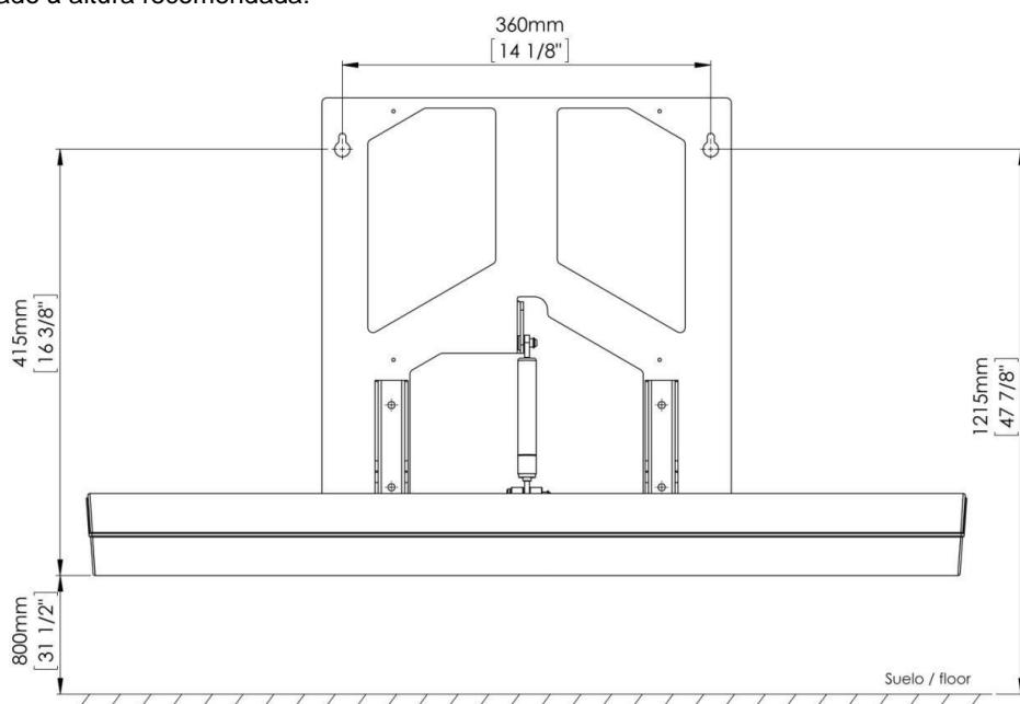
Segundo o esquema anterior marque em cima da parede os furos superiores da estrutura de fixação do trocador de fraldas com o lápis. É muito importante assegurar que as localizações marcadas com o lápis para os furos de montagem estão no mesmo nível que antes de realizar as perfurações.
