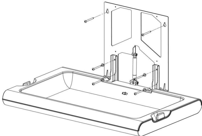
Zorg ervoor dat de zes schroeven waarmee de tafel aan de muur is bevestigd, goed zijn aangedraaid en dat de verschoontafel stevig aan de muur is gemonteerd.
