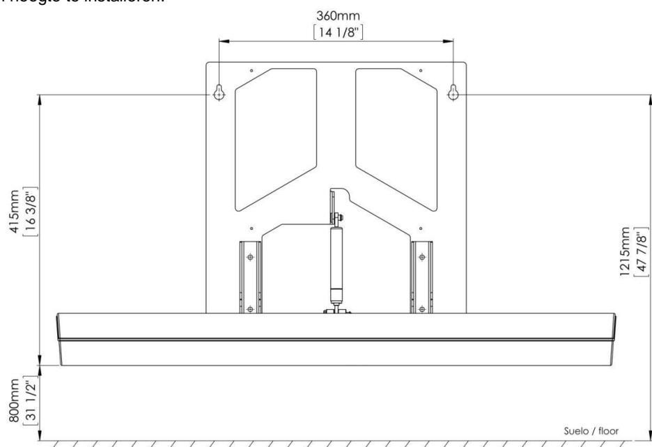
Markeer met het potlood volgens het bovenstaande schema de bovenste twee gaten van de draagstructuur van de verschoontafel op de wand. Het is van belang dat de gemarkeerde plekken voor de bevestigingsgaten op dezelfde hoogte liggen voordat u de gaten boort.
