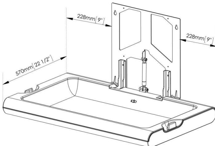
De aanbevolen montagehoogte is 800 mm vanaf de grond tot het laagste deel van de verschoontafel. De volgende tekening toont de hoogte waarop de gaten moeten worden gemaakt om de verschoontafel op de aanbevolen hoogte te installeren:
