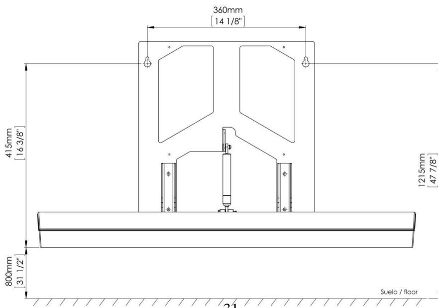
Nach der gleichen Vorgehensweise markieren Sie an der Wand mit dem Bleistift die zwei Stellen, an denen die oberen Löcher für die Halterung gebohrt werden sollen. Achten Sie vor dem Bohren darauf, dass die Positionen für die Löcher auf gleicher Höhe sind.
