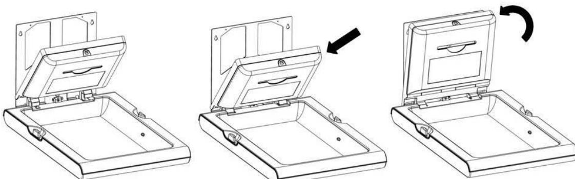
Abrir el dispensador de toalhinhas con la llave especial suministrada. Los cuatro orificios de fijação de este dispensador de toalhinhas a la estructura de fixação del trocador de fraldas quedarán a la vista.
