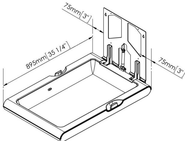
De aanbevolen montagehoogte is 800 mm vanaf de grond tot het laagste deel van de verschoontafel. De volgende tekening toont de hoogte waarop de gaten moeten worden gemaakt om de verschoontafel op de aanbevolen hoogte te installeren:
