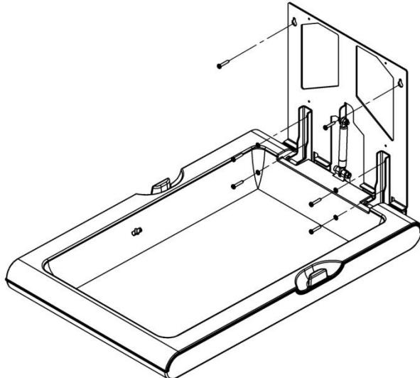
Stellen Sie sicher, dass alle sechs Befestigungsschrauben für die Wandhalterung richtig angezogen sind und der Wickeltisch fest an der Wand angebracht ist.
