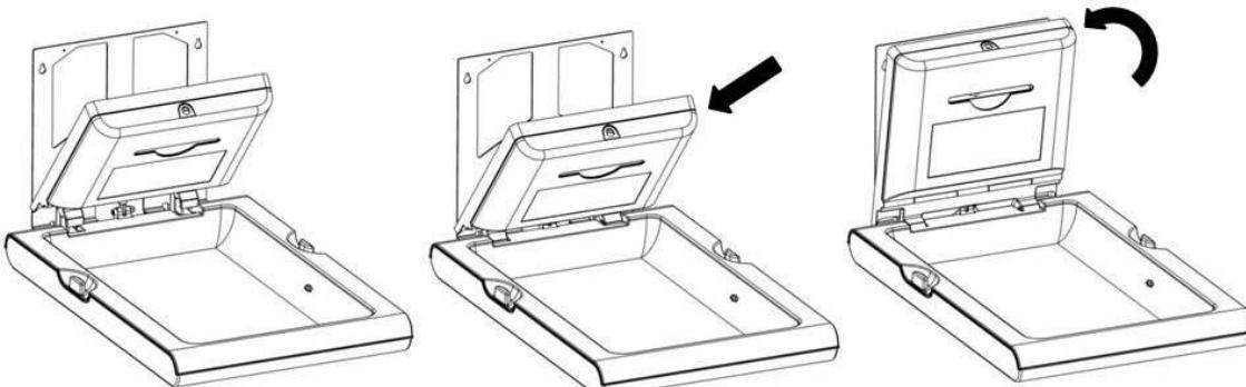
Откройте диспенсер для пеленок специальным ключом, поставленным в комплекте. Четыре отверстия для крепления данного диспенсера для пеленок к крепежной системе пеленального стола должны остаться на виду.
