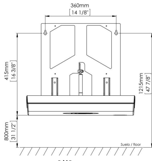
Nach der gleichen Vorgehensweise markieren Sie an der Wand mit dem Bleistift die zwei Stellen, an denen die oberen Löcher für die Halterung gebohrt werden sollen. Achten Sie vor dem Bohren darauf, dass die Positionen für die Löcher auf gleicher Höhe sind.
