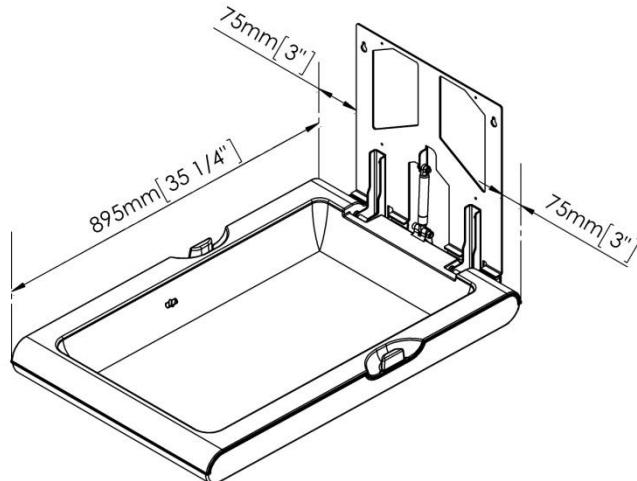
Für die Montage empfehlen wir einen Abstand von 800 mm zwischen Boden und niedrigstem Teil des Wickeltisches. Die nachfolgenden Skizzen zeigen auf welcher Höhe die Löcher gebohrt werden müssen, um den Wickeltisch auf der empfohlenen Höhe anzubringen:
