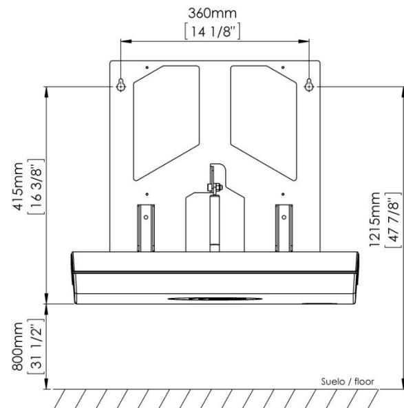
Следуя предыдущему рисунку, поставьте карандашом на стене пометки для двух верхних отверстий для крепежной структуры пеленального стола. До начала сверления отверстий очень важно убедиться в том, что поставленные карандашом пометки находятся на одном уровне.
