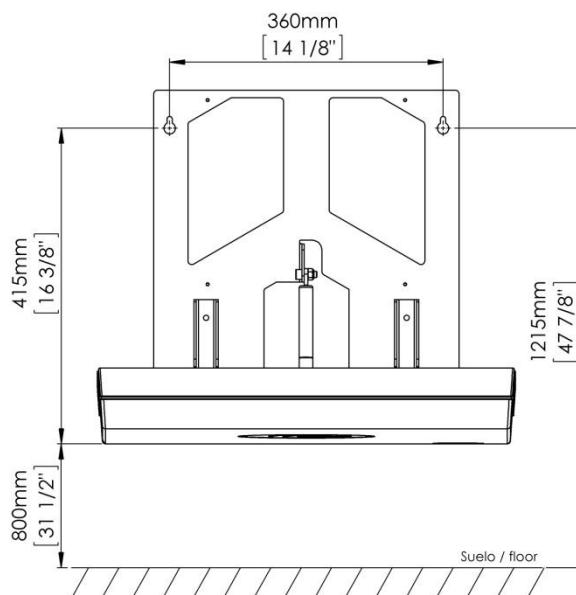
Markeer met het potlood volgens het bovenstaande schema de bovenste twee gaten van de draagstructuur van de verschoontafel op de wand. Het is van belang dat de gemarkeerde plekken voor de bevestigingsgaten op dezelfde hoogte liggen voordat u de gaten boort.
