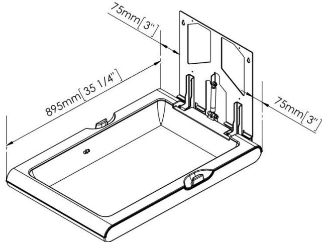
Рекомендованная высота установки — 800 мм от пола до самой нижней части пеленального стола. Следующий рисунок показывает, на какой высоте должны быть сделаны отверстия, чтобы пеленальный стол оказался установлен на рекомендованной высоте:
