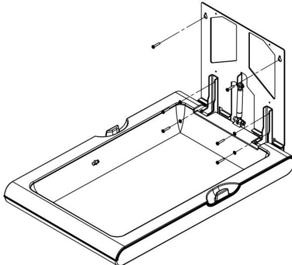
Comprobar que los seis tornillos de fijación de la unidad a la pared han sido correctamente apretados y que el cambia pañales se encuentra firmemente fijado a la pared.
