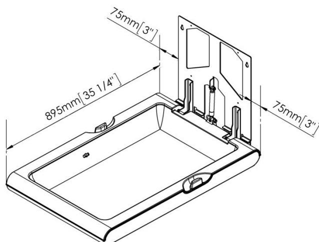
La hauteur recommandée d'installation est à 800 mm du sol jusqu'à la partie la plus basse de la table à langer. Le croquis suivant montre à quelle hauteur les trous doivent être percés pour que la table soit installée à la hauteur recommandée :
