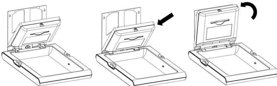
Abrir el dispensador de sabanitas con la llave especial suministrada. Los cuatro orificios de fijación de este dispensador de sabanitas a la estructura de sujeción del cambia pañales quedarán a la vista.
