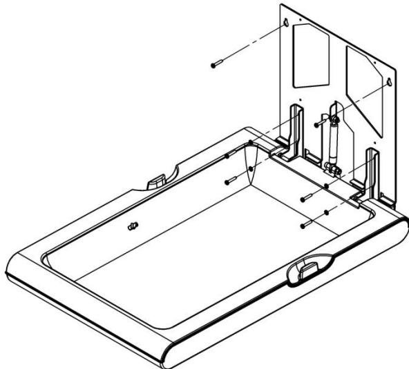
Comprove se os seis parafusos de fixação da unidade à parede foram apertados corretamente e se o trocador de fraldas está fixado à parede de maneira firme.
